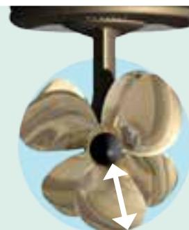
**NÚCLEO MÍNIMO PARA ÁREA DE PALA MÁXIMA** En Volvo Penta IPS, el escape no va a través del núcleo de la hélice. El pequeño diámetro del núcleo da lugar a un área de pala activa mayor y por tanto, a un agarre en el agua significativamente mejor.
