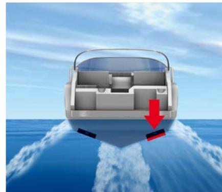
**Sistema de trimado automático para embarcaciones**
