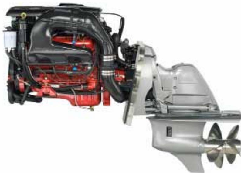
filtro de combustible y el depósito de refrigerante están situados en la parte delantera del motor para facilitar el acceso durante el servicio.
