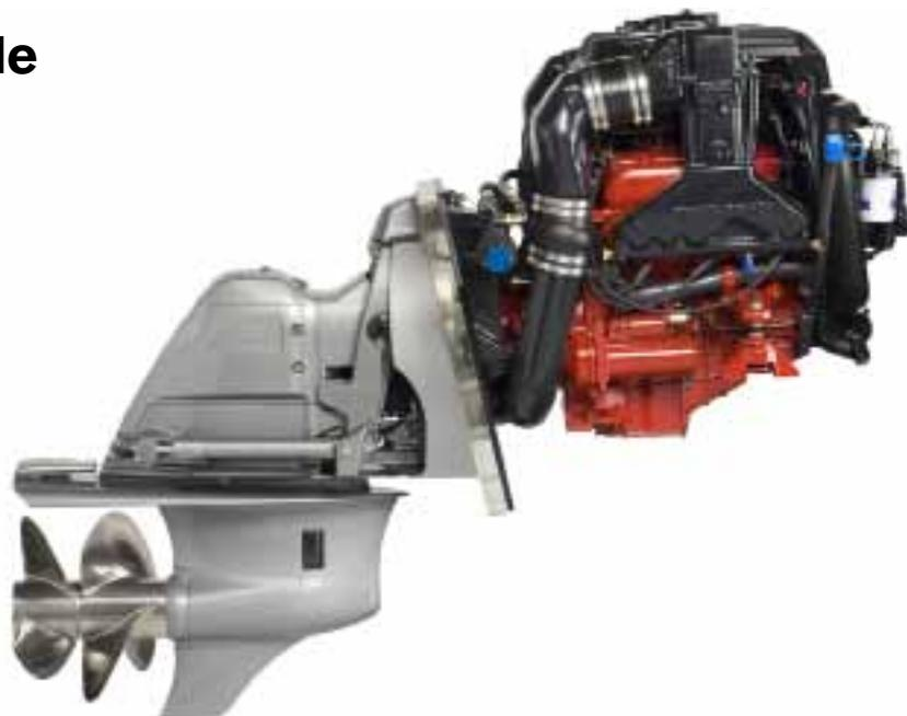
aceite, el filtro de combustible y el depósito de refrigerante están situados en la parte delantera del motor para facilitar el acceso durante el servicio. Los puntos de servicio tienen códigos de color.
