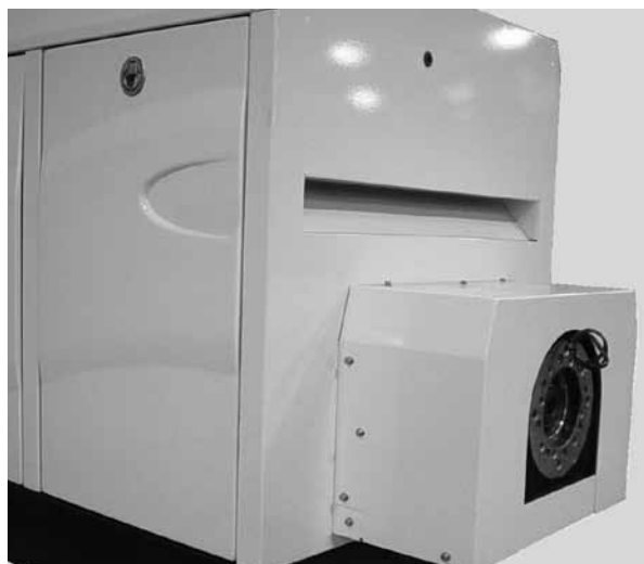
Instalación de PTO
