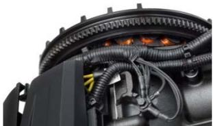
Sistema de carga sencillo con estator de 35 Amp con regulador de voltaje con enfriamiento
