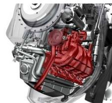
Sistema de admisión con efecto tuning por la parte superior que reduce el ruido e incrementa la eficiencia
