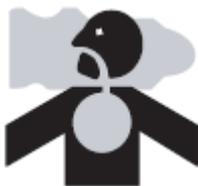
Cuando se utilice el motor como un generador portátil, no lo opere en interiores, como por ejemplo dentro de un depósito o túneles, o en un lugar pobremente ventilado. De ser imperiosa la utilización en interiores, descargue los gases de escape al exterior y ventile exhaustivamente el lugar. Asegúrese que los gases de escape no sean descargados directamente sobre edificios o seres vivos vecinos.
