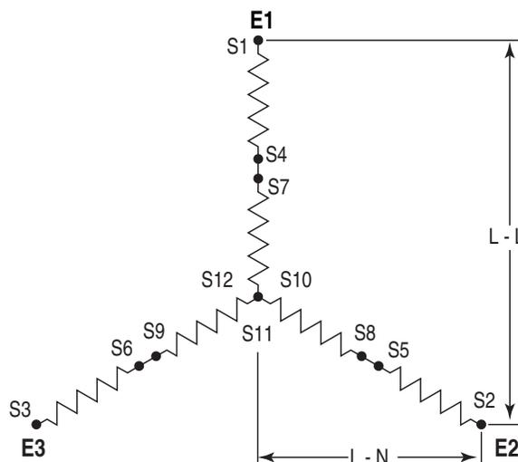
**Figura 7.4 - Conexiones del bobinado de alimentación eléctrica del estator - trifásica, 120/208 V (6 conductores)**
