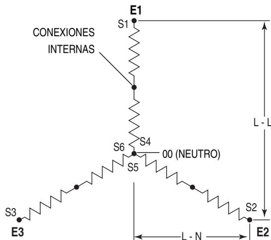
**Figura 7.3 - Conexiones del bobinado de alimentación eléctrica del estator - trifásica, 277/480 V (12 conductores)**
