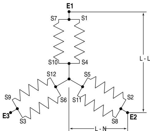
**Figura 7.6 - Conexiones del bobinado de alimentación eléctrica del estator - trifásica, 346/600 V (6 conductores)**
