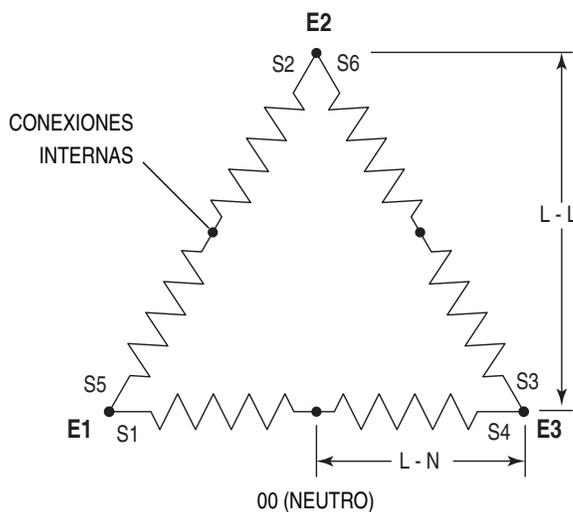
**Figura 7.8 - Conexiones del bobinado de alimentación eléctrica del estator - trifásica, 120/240 V (12 conductores)**
