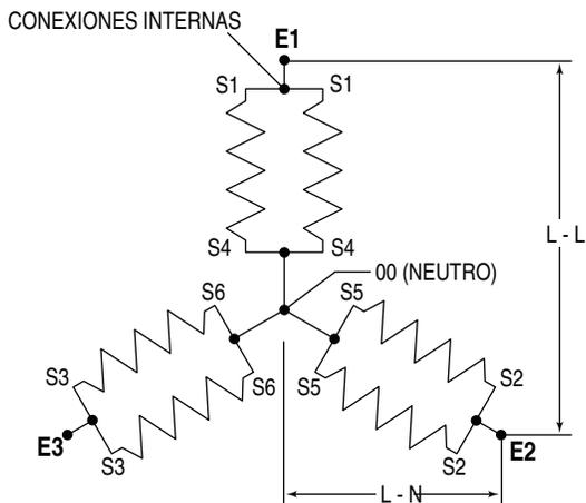
**Figura 7.5 - Conexiones del bobinado de alimentación eléctrica del estator - trifásica, 120/208 V (12 conductores)**
